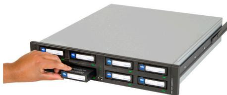
**Overland-Tandberg RDX QuikStation est un dispositif à base de disques amovibles hautement flexible pour la protection automatisée des données, la reprise après sinistre et l'archivage. La plateforme de stockage iSCSI est conçue pour offrir une solution flexible de protection des données et de récupération après sinistre hors site.**
